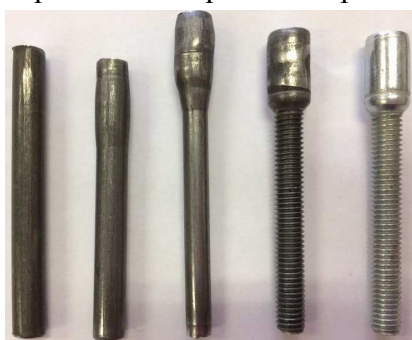
Рисунок 6. Технологический процесс изготовления резьбового наконечника троса
